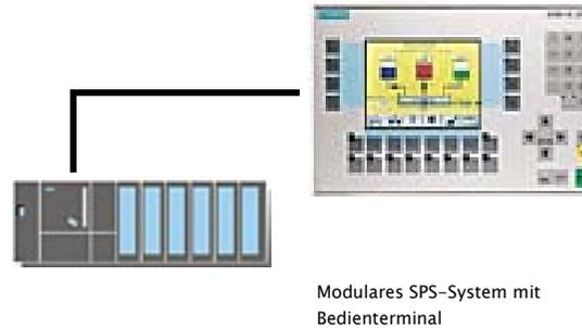
Modulares SPS-System mit Bedienterminal
